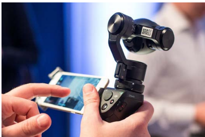
Les réglages de l'Osmo se font sur un smartphone via une application spécifique : DJI Go
