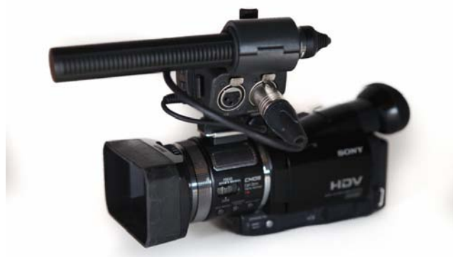
Le caméscope Sony HVR 1 A avec ses prises XLR
