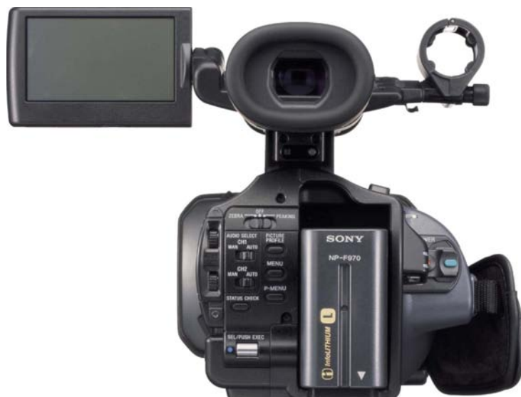
Contrôle de gain à l'arrière : manuel ou automatique
